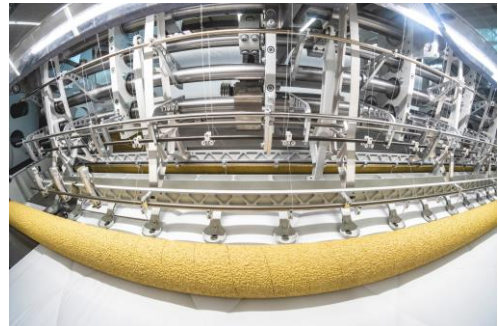
2031 Vielnadelnähmaschinen aus Köln machen 1700 Stiche in der Minute – und damit Steppnähte mit einer Länge von mehr als acht Metern.
