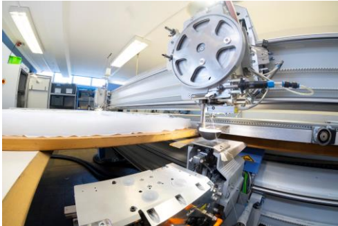
2005 Synchroner Verbund aus oberem Nähkopf und darunter liegender Unterfadenstation in einer CNC-gesteuerten Anlage.
