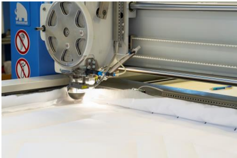
29890 Die Nähköpfe werden von Servoreglern aus der Reihe ARS 2000 SE von Metronix angetrieben.
