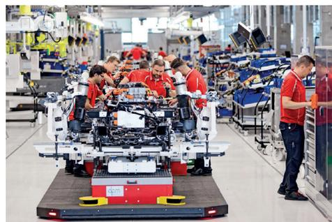
Zusammen mit den Partnern **DPM** und **Fritz Antriebstechnik** konnten SmartServo BL4840-M erfolgreich als Fahrtrieb in Flurförderfahrzeuge der Firma DPM integriert und vernetzt werden. Die **Fahrerlosen Transportsysteme** (FTS) der Firma DPM werden eingesetzt, um Premium Elektrofahrzeuge bei Porsche in Zuffenhausen in zwei Fertigungslinien zu transportieren.
