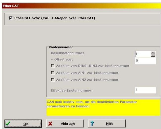
Über das Kontrollkästchen **EtherCAT aktiv (CoE CANopen over EtherCAT)** wird die EtherCAT-Kommunikation mit dem CoE-Protokoll ( CANopen over EtherCAT ) ein- bzw. ausgeschaltet.
