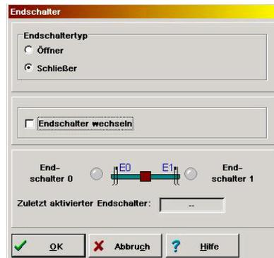
Über das Kontrollkästchen **Endschalter wechseln** kann auch die Zuordnung der beiden digitalen Eingänge DIN 6 und DIN7 zu den Endschaltern E0 und E1 getauscht werden. Der physikalische Endschalter, der an DIN6 angeschlossen ist, übernimmt die Wirkungsweise von dem Endschalter, der an DIN7 angeschlossen ist, und umgekehrt. Die funktionelle Zuordnung kann damit flexibel gewechselt werden, ohne die Verdrahtung am Servopositionierregler ändern zu müssen.
