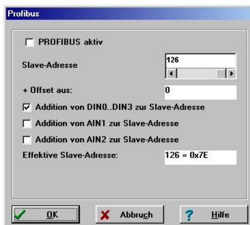
Die PROFIBUS-DP-Kommunikation kann über das Feld Profibus aktiv ein- und ausgeschaltet werden.
