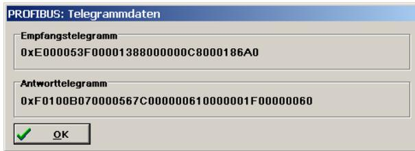
Anhand der dargestellten Zeichen ist es z.B. möglich, Zuordnungen von Daten bzw. Vertauschungen in Datenfeldern zu erkennen. Die Reihenfolge der Bytes für 2 Byte bzw. 4 Byte Datentypen entspricht stets „High Byte ... Low Byte“. Zur Interpretation der Daten empfiehlt sich den Vergleich mit den Einstellungen im Telegrammeditor (Menü **Parameter\Feldbus\PROFIBUS\Telegrammeditor**).
