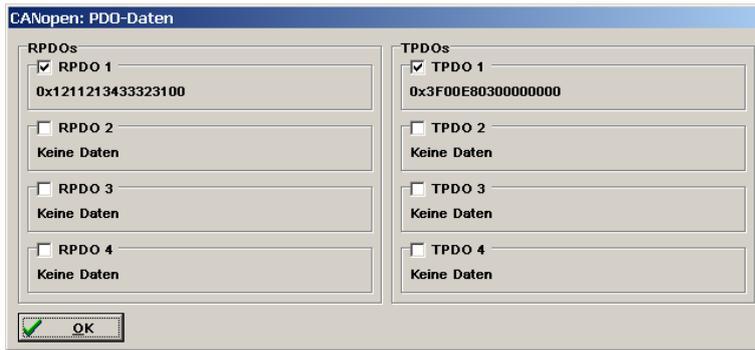
Anhand der dargestellten Zeichen ist es z.B. möglich, Zuordnungen von Daten bzw. Vertauschungen in Datenfeldern zu erkennen. Die Reihenfolge der Bytes für 2 Byte bzw. 4 Byte Datentypen entspricht stets „Low Byte ... High Byte“. Zur Interpretation der Daten empfiehlt sich den Vergleich mit dem eingestellten PDO-Mapping (s. Menü **Parameter\Feldbus\CANopen\PDO-Konfiguration**).
