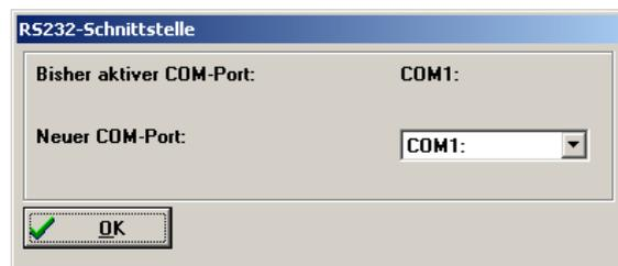
Wählen Sie den korrekten COM-Port aus und betätigen die Schaltfläche **OK**. Das Parametrierprogramm versucht anschließend, eine Verbindung aufzubauen. Dazu werden verschiedene Baudraten durchsucht. Wenn keine Verbindung aufgebaut werden konnte, wird eine Fehlermeldung ausgegeben, andernfalls kommuniziert das Programm über den neuen Port.
