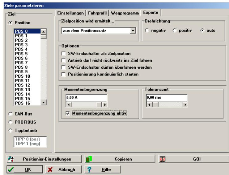
Über die Auswahlliste **Zielposition wird ermittelt...** wird angegeben, aus welcher Quelle das Ziel für die aktuelle Positionierung stammt:
