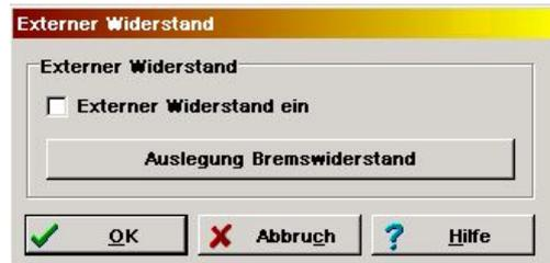
Mit Betätigung der Schaltfläche **Auslegung Bremswiderstand** starten Sie einen so genannten „Bremswiderstand-Assistent“. Dieser hilft bei der Beurteilung, ob der interne Bremswiderstand ausreichend ist und versucht, die Grenzparameter des eventuell erforderlichen externen Widerstandes zu ermitteln.
