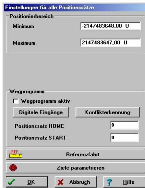
Bei absoluten Positionierungen wird jede neue Zielposition auf Einhaltung der Grenzen für den absoluten Positionierbereich überprüft. Die Parameter **Minimum** und **Maximum** im Feld **Positionierbereich** geben die absoluten Positionsgrenzen für den Lage-Sollwert und den Lage-Istwert an. Der Positionierraum bezieht sich immer auf die Nullposition des Antriebes (siehe auch das *Kapitel 11.3.3 Referenzfahrt, Seite 113*).
