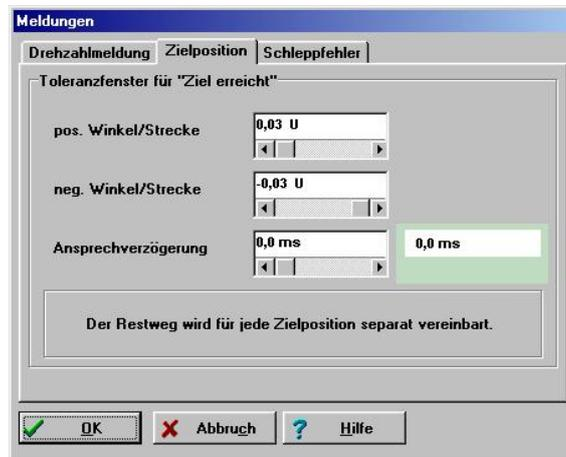
Mit diesen Parametern kann man die Funktion  $X_{ist} = X_{Ziel}$  eines digitalen Ausgangs steuern.
