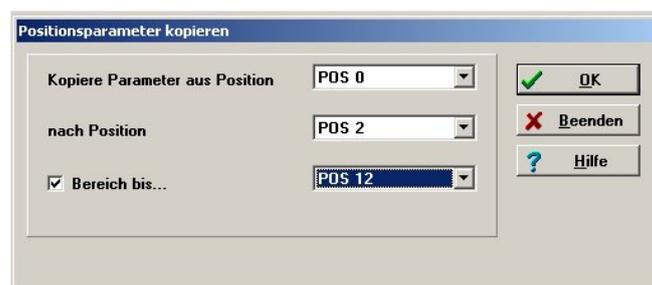
Sie können eine Quellposition auf eine einzelne Zielposition kopieren. Füllen Sie dafür die beiden oberen Felder aus. Wenn Sie eine Position auf mehrere Positionen kopieren wollen, aktivieren Sie das Kontrollkästchen **Bereich bis...** Im dritten Feld geben Sie dann die letzte Zielposition an.
