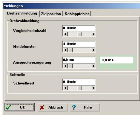
Mit den Parametern **Vergleichsdrehzahl**, **Meldefenster** und **Ansprechverzögerung** kann man die Funktion **Vergleichsdrehzahl erreicht** eines digitalen Ausganges steuern.
