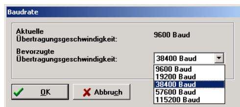
Dazu wird eine **Bevorzugte Übertragungsgeschwindigkeit** ausgewählt. Der Metronix ServoCommander™ versucht, mit der vorgegebenen Baudrate eine Kommunikation aufzubauen, woraufhin die bevorzugte Übertragungsgeschwindigkeit akzeptiert oder auf eine niedrigere Baudrate zurückgeschaltet wird. Die realisierte Baudrate wird als **Aktuelle Übertragungsgeschwindigkeit** angezeigt.
