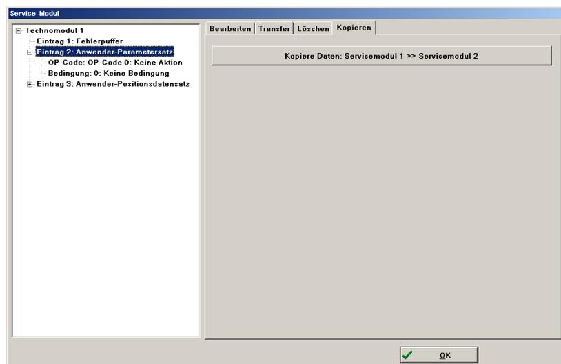
Damit diese Funktion ausgeführt werden kann, muss sowohl Technologieschacht 1 als auch Technologieschacht 2 mit einem Service-Modul bestückt sein. Es ist nur möglich, die Daten von Service-Modul1 auf Service-Modul 2 zu kopieren. Ein Kopiervorgang ist nur möglich, wenn die Endstufe des Servopositionierreglers nicht aktiv ist.
