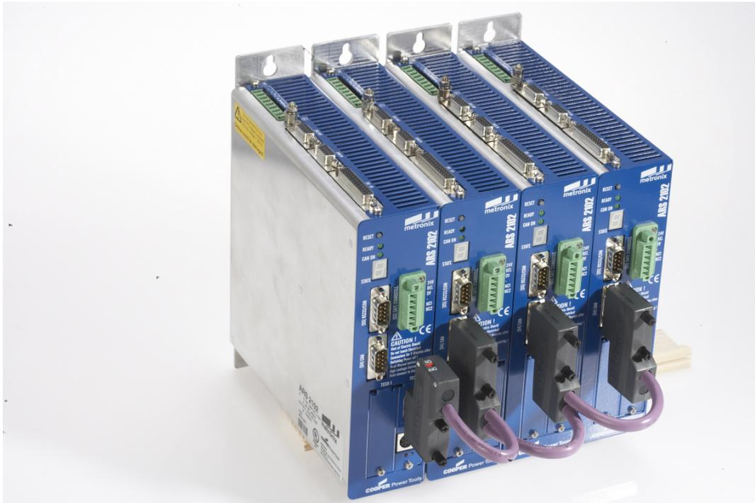
Abbildung 4: Beispiel einer CAN-Bus-Verdrahtung eines 4-Achssystems
