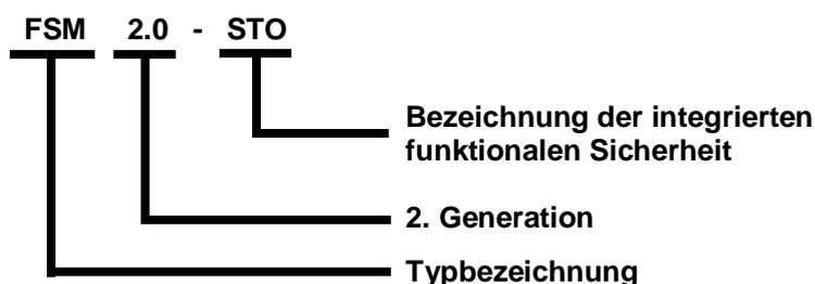
Abbildung 1: Typenschlüssel am Beispiel des FSM 2.0 - STO
