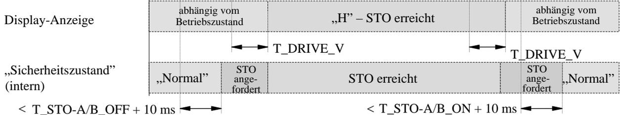
**Abbildung 4: Basis-Zeitverhalten beim Aktivieren und Deaktivieren der Sicherheitsfunktion STO**
