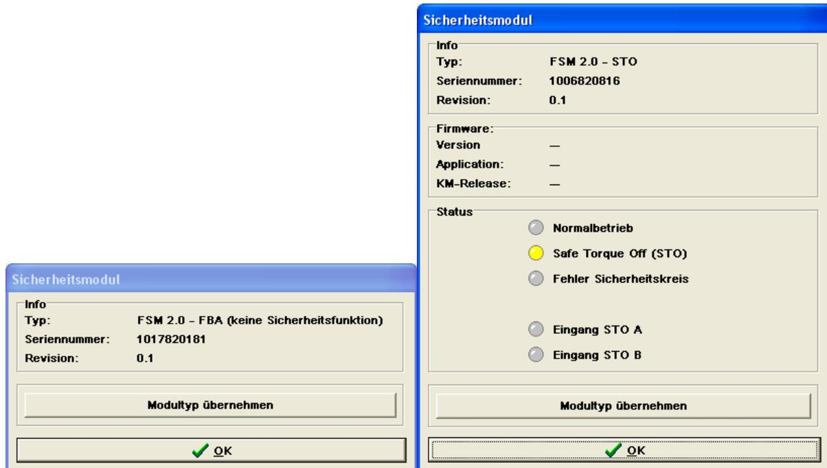
Abbildung 12: Fenster Sicherheitsmodul für FSM 2.0 – FBA (links) und FSM 2.0 – STO (rechts)
