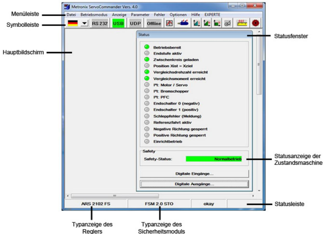
Abbildung 10: Typanzeige des Sicherheitsmoduls und erweitertes Status-Fenster
