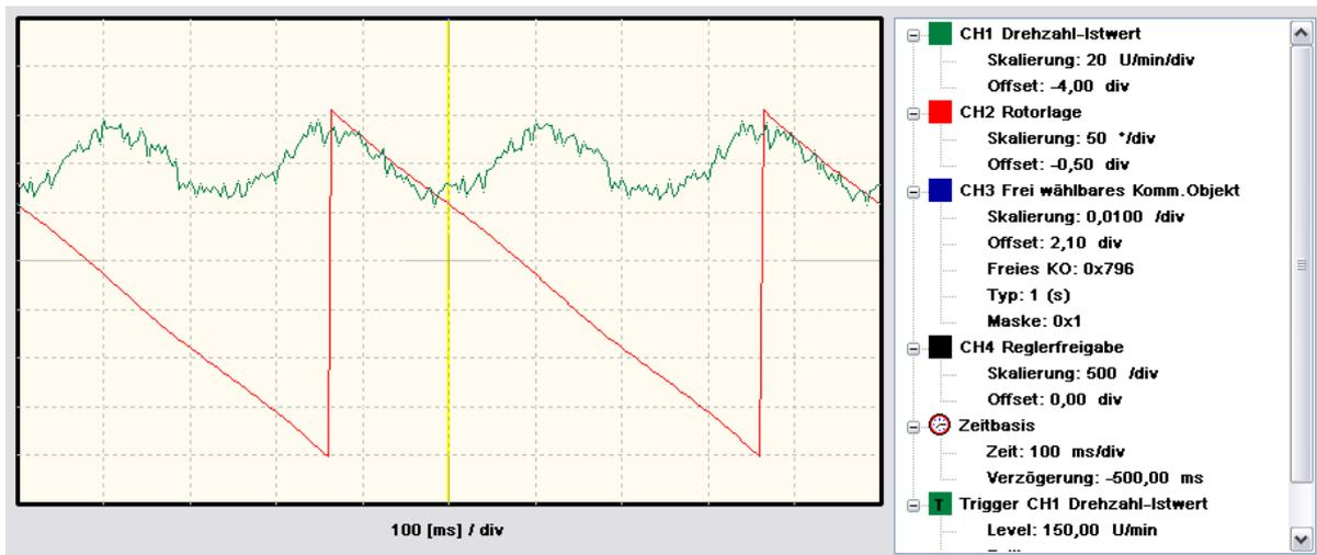
**Abbildung 71: Fehlerkurven auf dem Geschwindigkeitssignal (CH1) bei einer Verringerung der Signalamplitude von  $e_x$  um 10%. Es ergibt sich eine Drehzahlwelligkeit von ebenfalls 10%. Die Messung erfolgte bei Fremdantrieb der Welle mit konstanter Drehzahl.**
