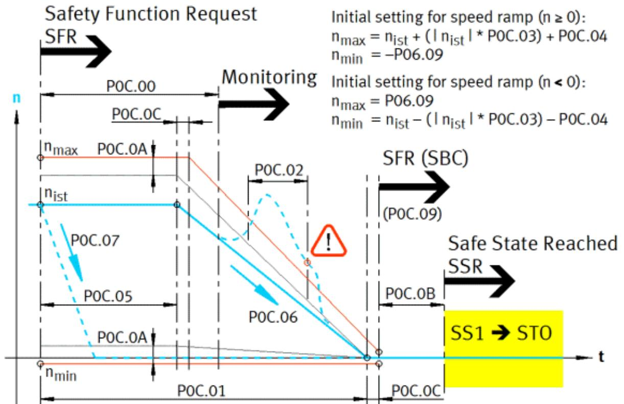
Abbildung 21: Ablaufdiagramm SS1
