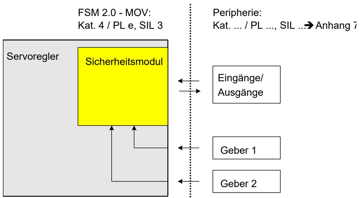
**Abbildung 2: Sicherheitsniveau FSM 2.0 – MOV und Gesamtsystem**
