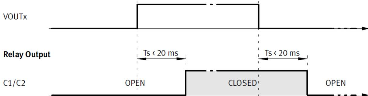
Abbildung 37: Timingdiagramm des potentialfreien Meldekontaktes
