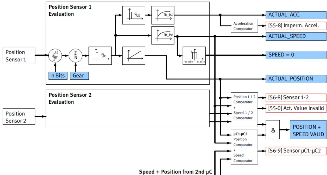
Abbildung 7: Berechnung der Geschwindigkeit und der Beschleunigung
