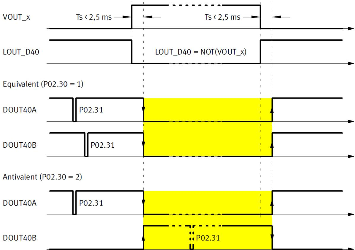
**Abbildung 33: Timingdiagramm der zweikanaligen sicheren Ausgänge**
