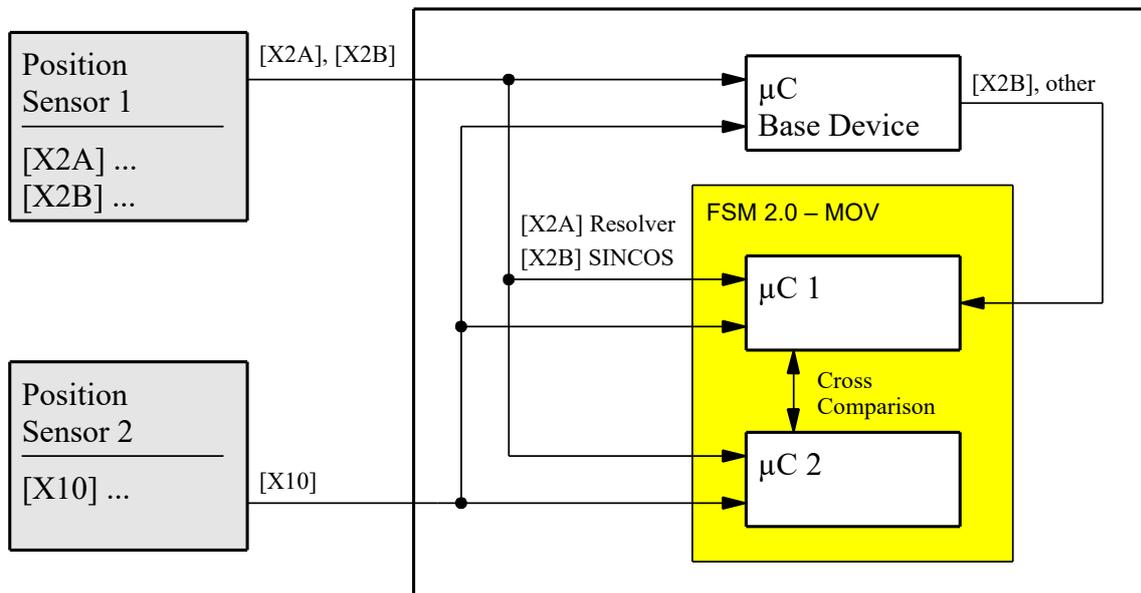
Abbildung 6: Auswertung der Positionssensoren auf dem Sicherheitsmodul
