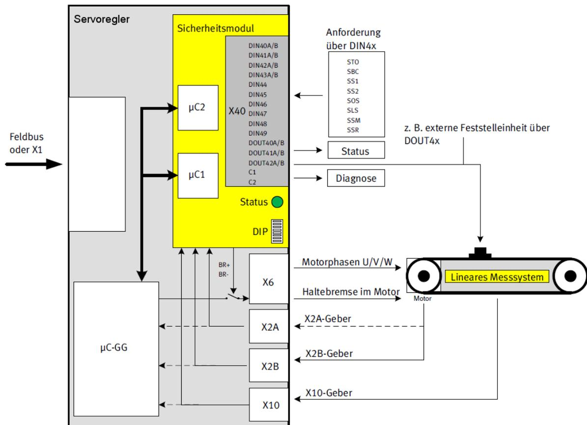
Abbildung 4: Funktionsprinzip Sicherheitsmodul
