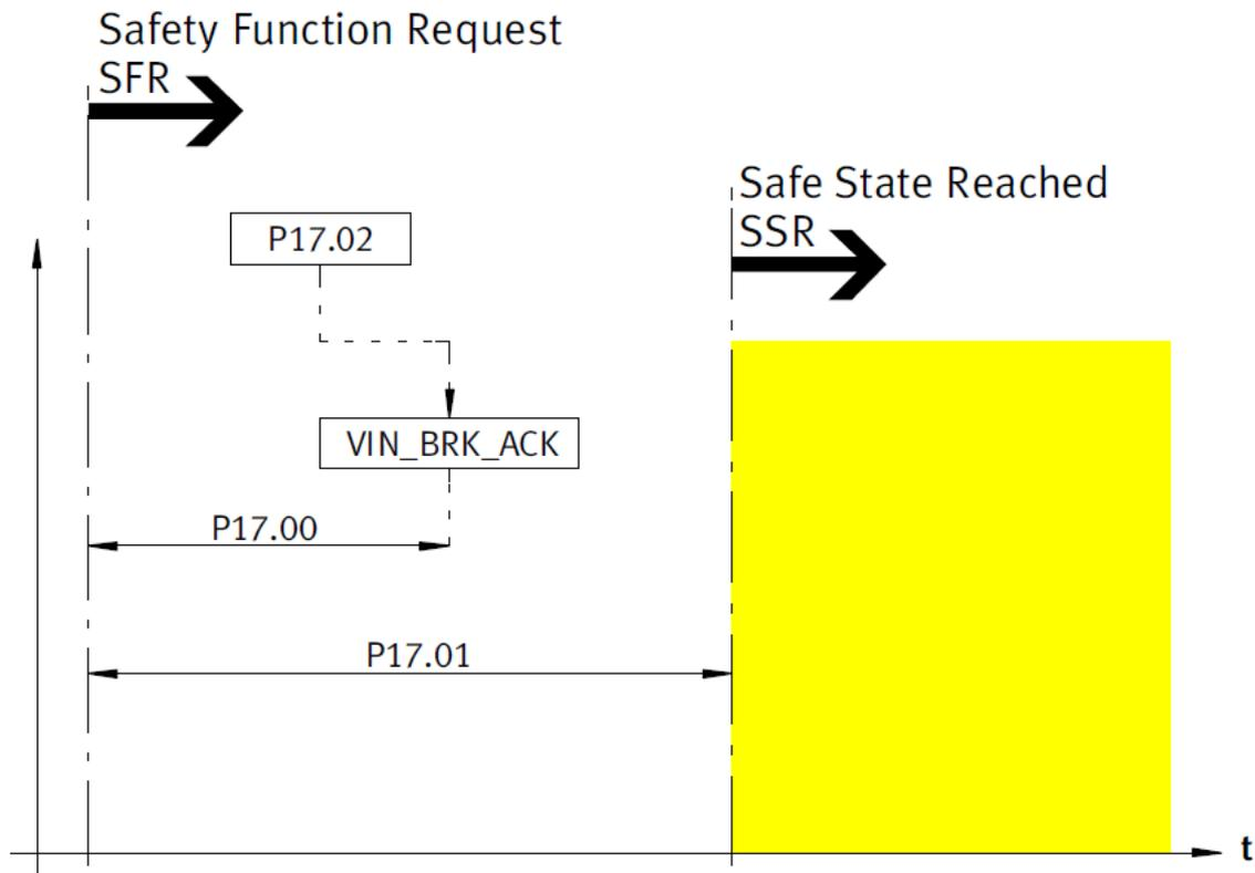
Abbildung 19: Ablaufdiagramm SBC
