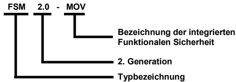
Abbildung 1: Typenschlüssel am Beispiel des FSM 2.0 - MOV
