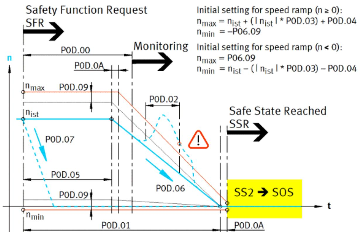
Abbildung 23: Ablaufdiagramm SS2
