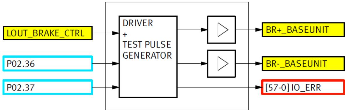
Abbildung 34: Blockschaltbild der sicheren Bremsansteuerung im Grundgerät
