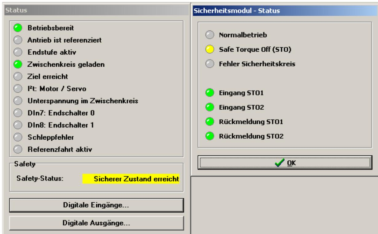
Abbildung 15: Fenster „Status“ allgemein und „Sicherheitsmodul – Status“ im Modus „Sicherer Zustand erreicht“
