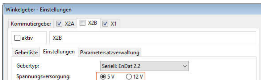
Abbildung 149: Winkelgeber-Einstellungen: Parametrierung der Versorgungsspannung
