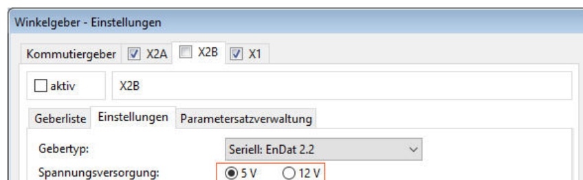
Abbildung 149: Winkelgeber-Einstellungen: Parametrierung der Versorgungsspannung
