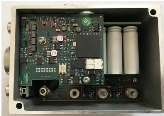
Abbildung 1: Optische Kontrolle des Servoreglers (Bus- und Leistungsplatine)
