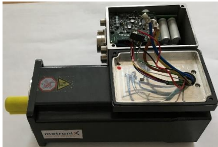
Abbildung 5: Servomotor und Servoregler platzieren
