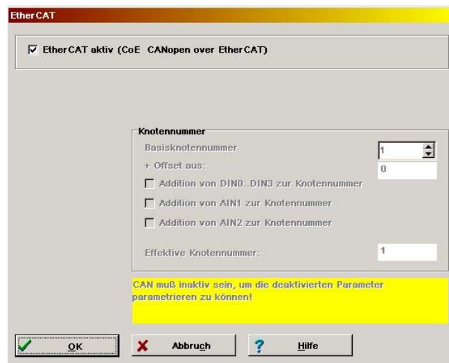
Abbildung 10: Einstellung der EtherCAT-Schnittstelle
